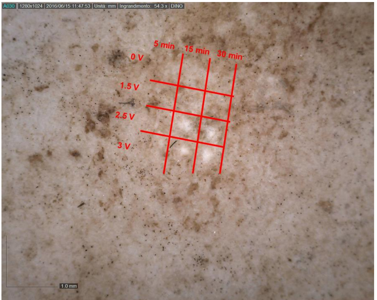
Figura 3. 5 Campione di carta da lettere sul quale sono stati eseguiti gli spot test; immagine registrata con il microscopio digitale a contatto a 54.3x con schema riassuntivo dell'etching localizzato.
