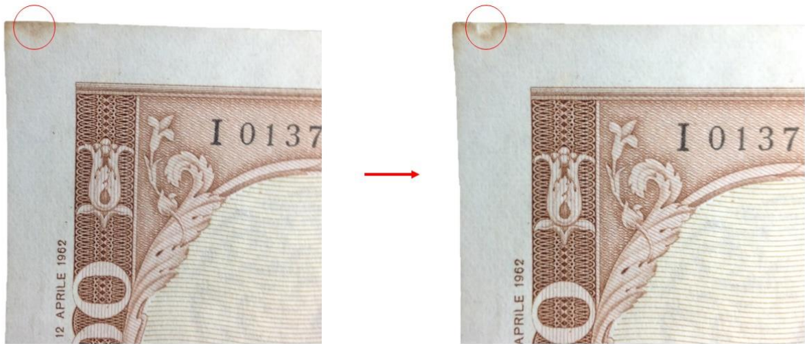
Figura 3. 10Campione B1, 10000 lire, pre (sx) e post (dx) trattamento sbiancante tramite microcapillare per 2 min.
