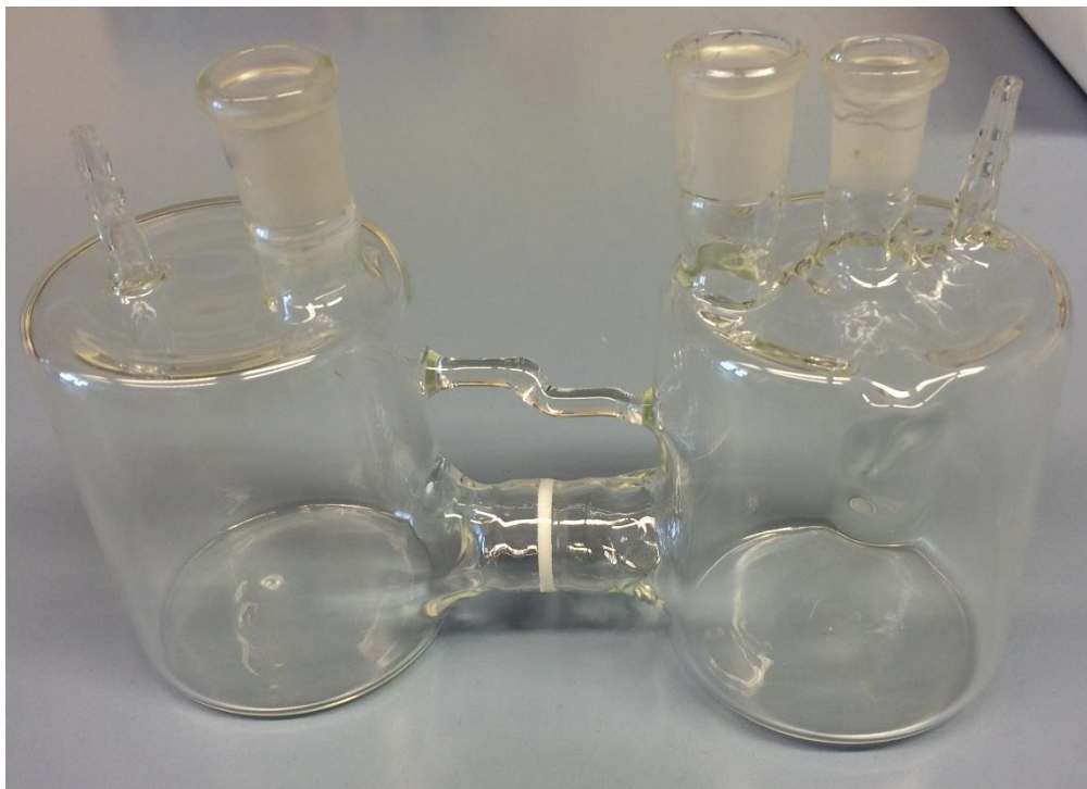
Figura 3. 11 Cella elettrolitica realizzata per i test di bleaching.
