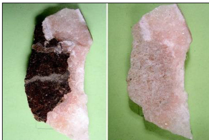
Figura 7. Immagine di un frammento di pietra ricoperto da una crosta nera prima (a) e dopo l'applicazione del D. vulgaris (Cappitelli et al. , 2006).
