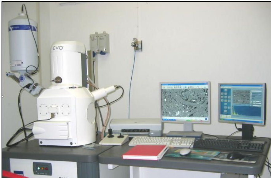
Figura 19. Microscopio elettronico a scansione corredato di microanalisi in dotazione all'Istituto Centrale per il Restauro e la Conservazione del Patrimonio Archivistico e Librario (SEM-VP EVO 50 XVP Carl-Zeiss Electron Microscopy Group + EDS Inca Energy 250 Oxford).
