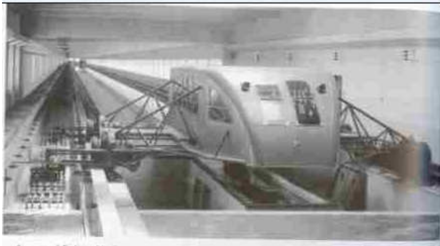
Figura 4: Il Carro dinamometrico della vasca idrodinamica
